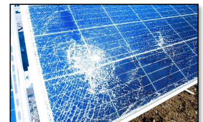
石や雷で割れたパネル
