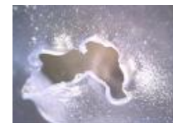
試験による穴 (約6.65mm)
