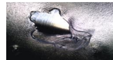
試験による穴 (約4.93mm)
