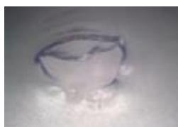
試験による穴 (約4.90mm)
